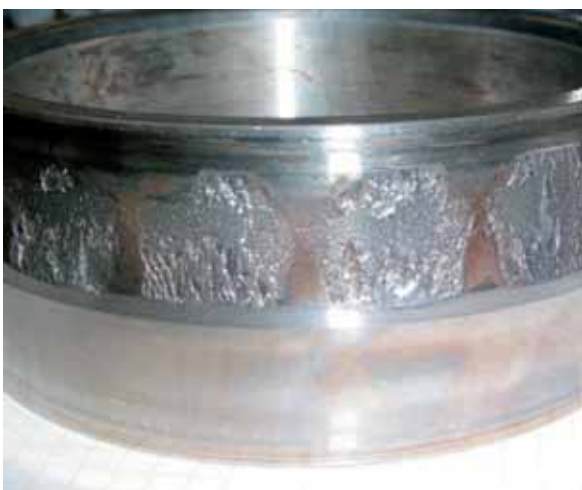
Bild 2: Ein Lager, das durch unsachgemäßen Einbau beschädigt wurde
